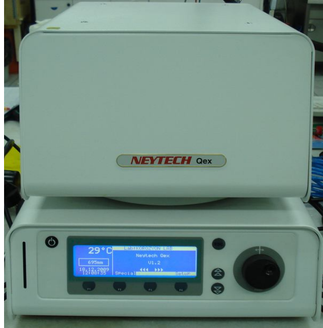
Şekil 4.7. Kurutma işleminde kullanılan fırın.
