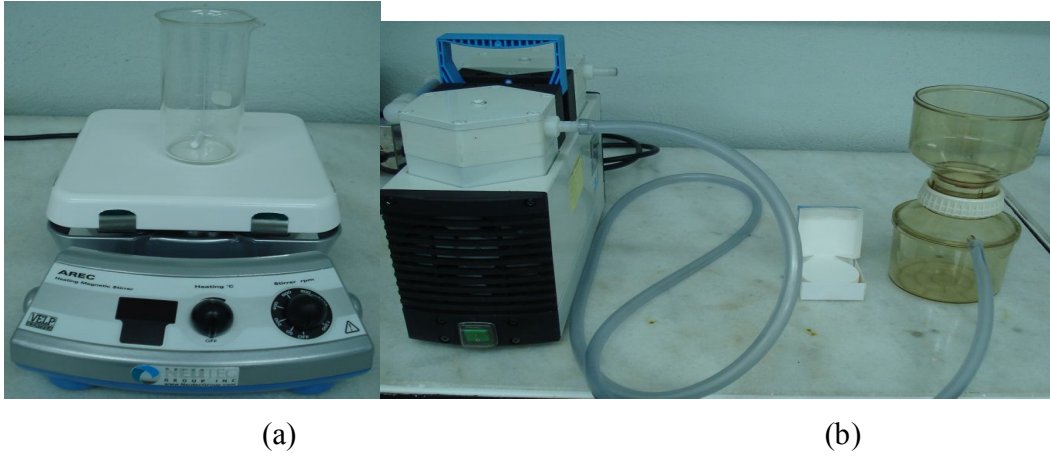
Şekil 4.8. Kaplama ve filtreleme işlemlerinde kullanılan, a) manyetik karıştırıcı, b) filtre ve vakum ünitesi.
