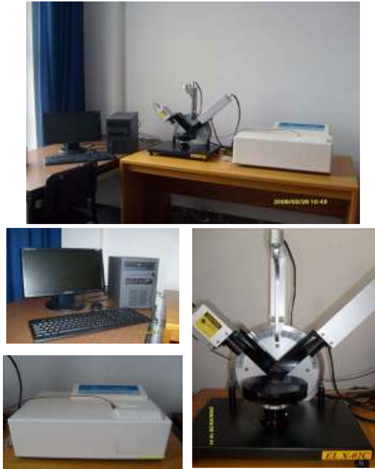
Şekil 3.3. Spektroskopik elipsometre cihazı ve parçalarının fotoğrafları.
