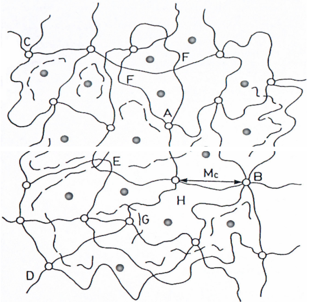
Şekil 2.1.Çapraz bağlı hidrojelın yapısı. A; Dört fonksiyonlu, B; Çok fonksiyonlu çapraz bağları göstermektedir. C ve D; Zincir uçlarıdır. E; Dolaşmış ve birbirine karışmış zincirleri göstermektedir. F; İki zincir takılmasını göstermektedir. G; Çapraz bağlanmamış küçük zincirleri gösterir. M_c ; İki çapraz bağ merkezi arasındaki zincirin molekül kütlesidir. H; difüzyon için uygun olan çapraz bağlar arasındaki boşluk. ● ; Çapraz bağlar arasındaki boşluklara difüzyonlanan çözücü.
