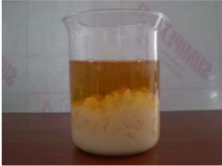
Şekil 4.4 Aşırı metanolle yıkama sonrası ayrılan gliserin ve tuz çöktürüsü
