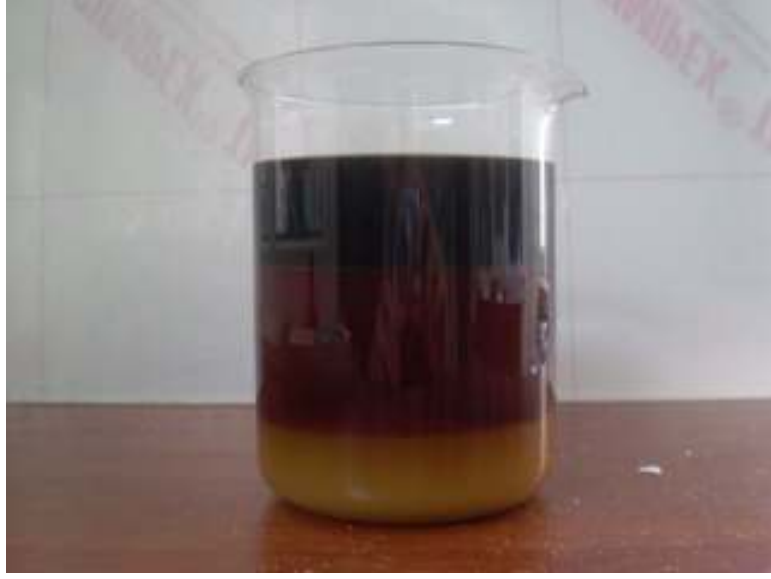
Şekil 4.3 Fosforik asit ilavesi sonrası oluşan üç faz: Üst faz yağ asitleri, orta faz gliserin ve alt fazda tuzlar
