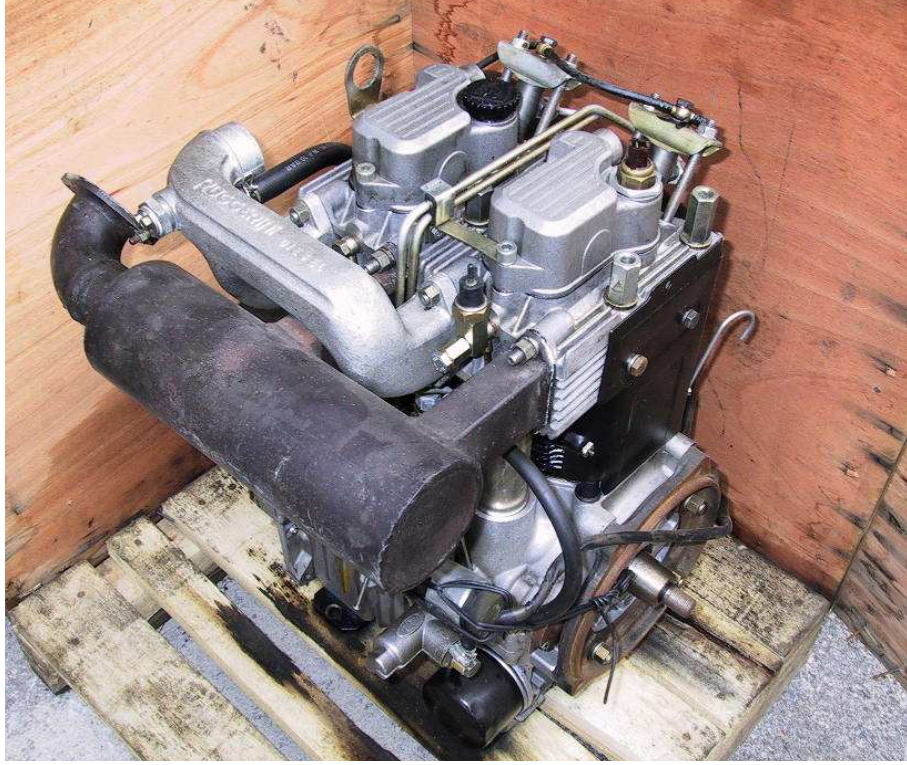
Şekil 6.7. RD 270 Ruggerini Dizel Motor
