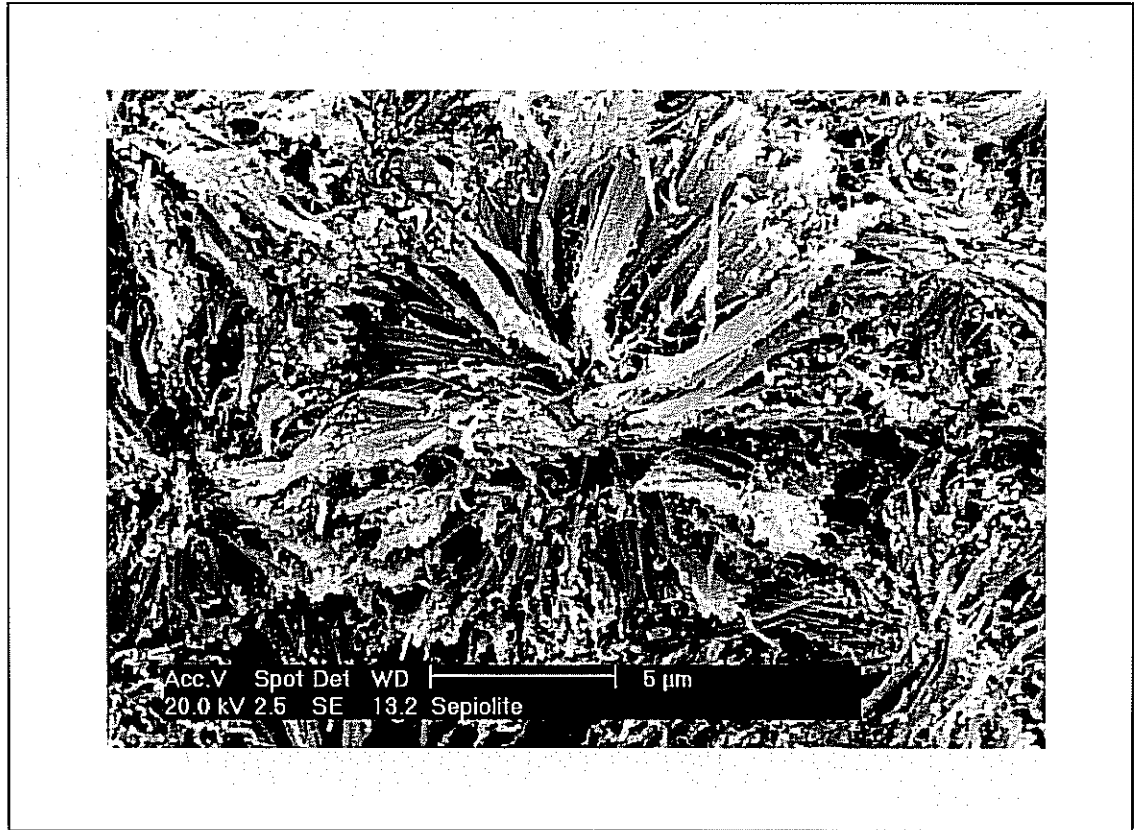
Şekil 2. 5. Eskişehir sepiyolitinin lif demetlerinin SEM'de görünümü( M. Roe, Macaulay Collection)[7].
