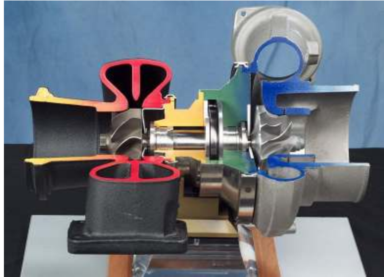
Şekil 3.2 Turboşarjın kesit görünüşü ( http://tr.wikipedia.org , 2008)
