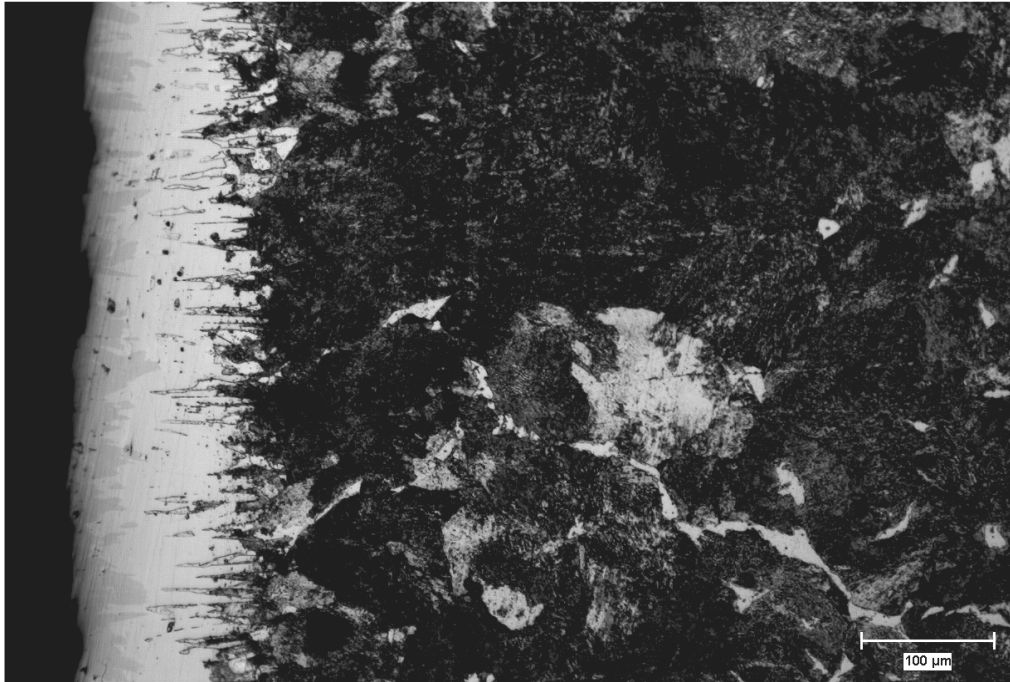
Şekil 4.3. 900 °C'de 4 saat borlama işlemine tabi tutulan AISI 1030 çeliğinin mikroyapısı (200X).
