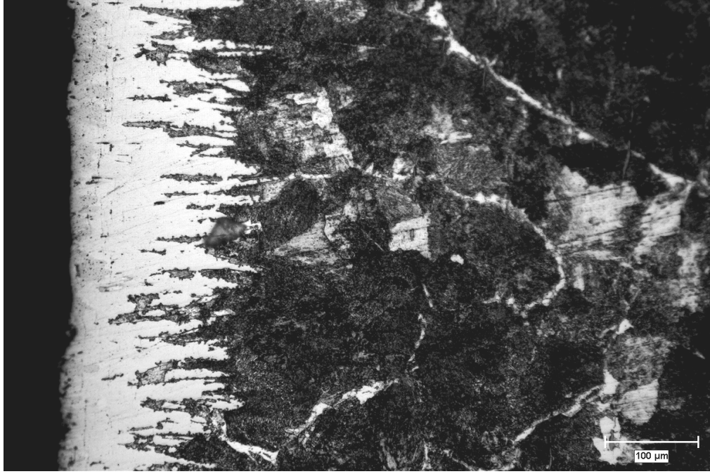
Şekil 4.6. 950 °C'de 4 saat borlama işlemine tabi tutulan AISI 1030 çeliğinin mikroyapısı (200X).
