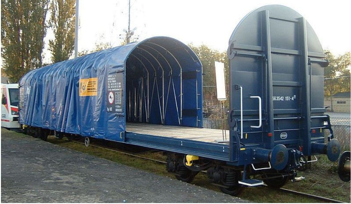
Şekil 4.2 Tenteli Vagonun Açık Konumda Görünüşü ( http://www.tcdd.gov.tr/yuk/vagonlar.htm )
