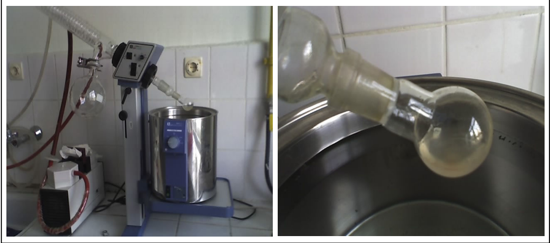
Şekil 2.33. Çözücünün Rotary Evaporator’ de yoğunlaştırılarak antimikrobiyal etkili maddeden uzaklaştırılması
