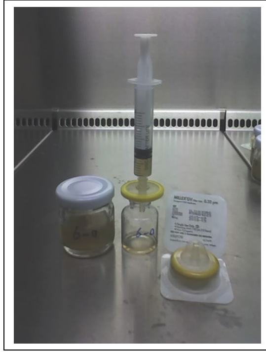
Şekil 2.26. Fermentasyon sıvısının filtre ile steril edilmesi.
