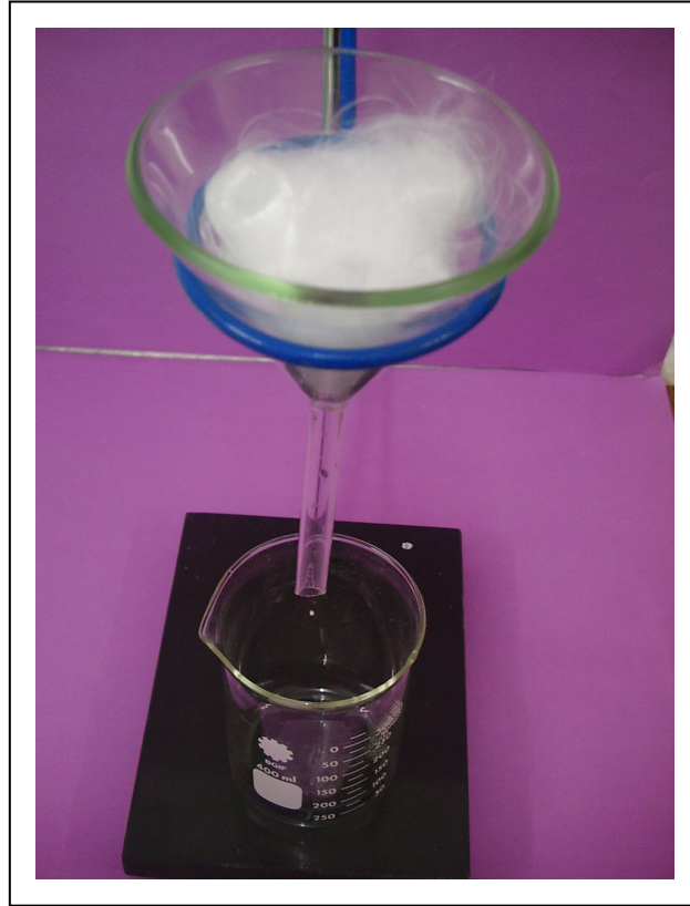
Şekil 2.32. Aktif maddenin, huni içindeki cam yününden geçirme işlemi
