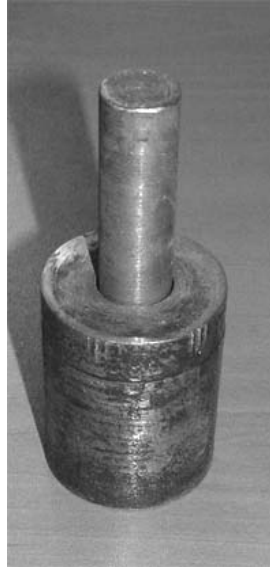
Şekil 5.3. Toz B 2 O 3 ve magnezyumun sıkıştırılıp pellet haline getirildiği kalıp
