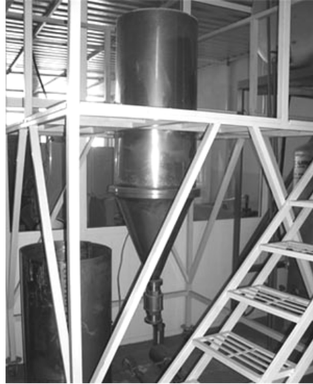
Şekil 5.2. Magnezyum tozunun üretildiği siklon
