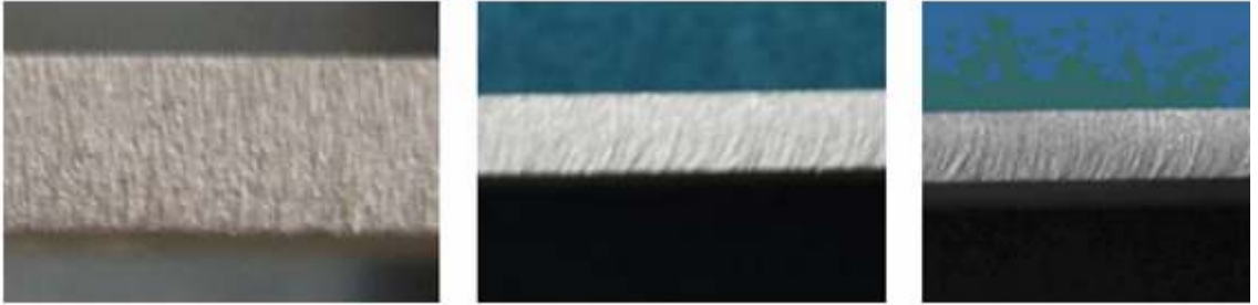
Şekil 5.150. A Tipi Uygulamada Çizik Oluşumu. Malzeme: Alüminyum; Kalınlık: 4 mm; İlerleme Hızları: 700, 1200 ve 1500 mm/dk; Basınç: 3000 bar (MAJET, İstanbul, 2006)
