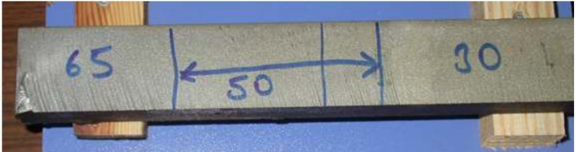
Şekil 5.143. A Tipi Uygulamada Çizik Oluşumu. Malzeme: St-42; Kalınlık: 30 mm; İlerleme Hızları: 30,50 ve 65 mm/dk; Basınç: 3000 bar (MAJET, İstanbul, 2006)
