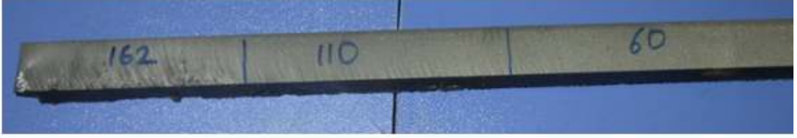
Şekil 5.144. A Tipi Uygulamada Çizik Oluşumu. Malzeme: St-42; Kalınlık: 20 mm; İlerleme Hızları:60,110 ve 162 mm/dk; Basınç: 3000 bar (MAJET, İstanbul, 2006)
