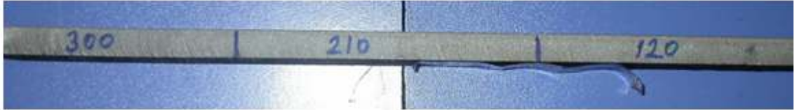
Şekil 5.146. A Tipi Uygulamada Çizik Oluşumu. Malzeme: St-42; Kalınlık: 10 mm; İlerleme Hızları: 120, 210 ve 300 mm/dk; Basınç: 3000 bar (MAJET, İstanbul, 2006)
