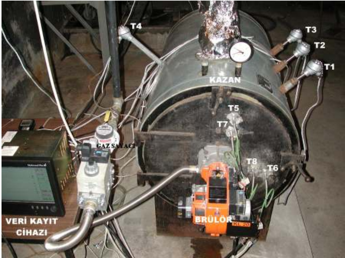
Şekil 5.11. Kazana bağlanan termoelemanların görünüşü
