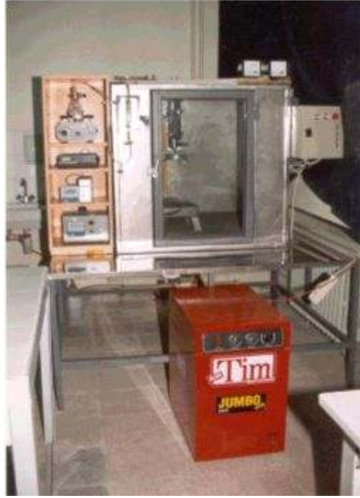
Şekil 2.2. Ultrasonik kimyasal püskürtme tekniğinin fotoğrafı.
