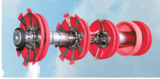
Şekil 3.4. Geometri ölçüm PIG'i.
