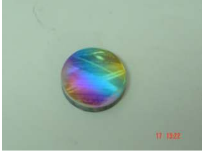
Şekil 7.2. TVA sisteminde çelik üzerine kaplanan bor ince filmin fotoğrafı.
