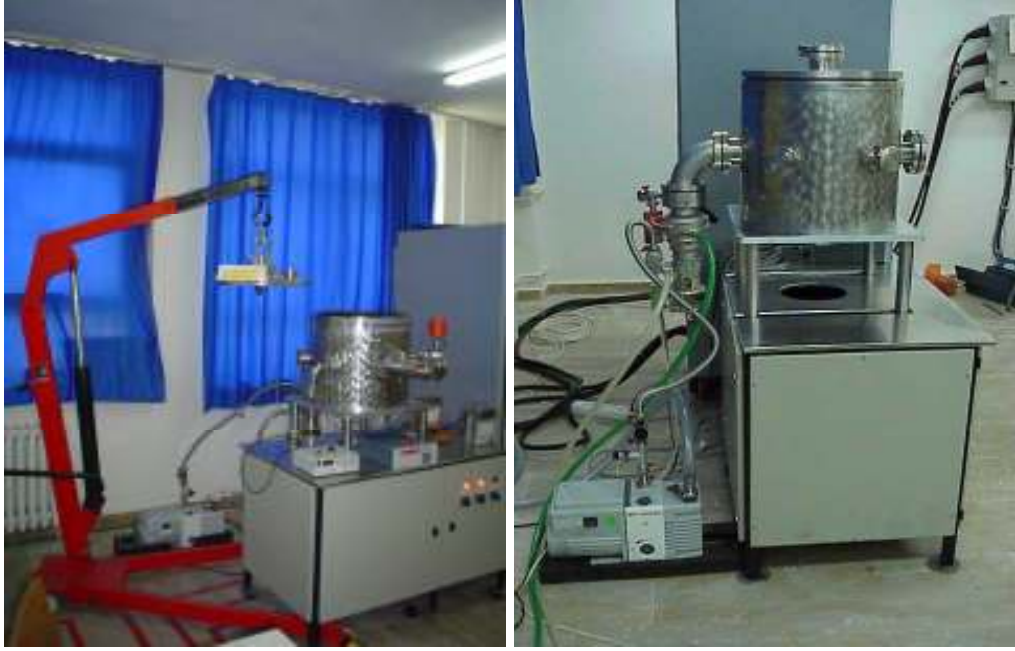
Şekil 5.2. TVA sisteminin yandan görünüşü (vakum pompası ile birlikte).
