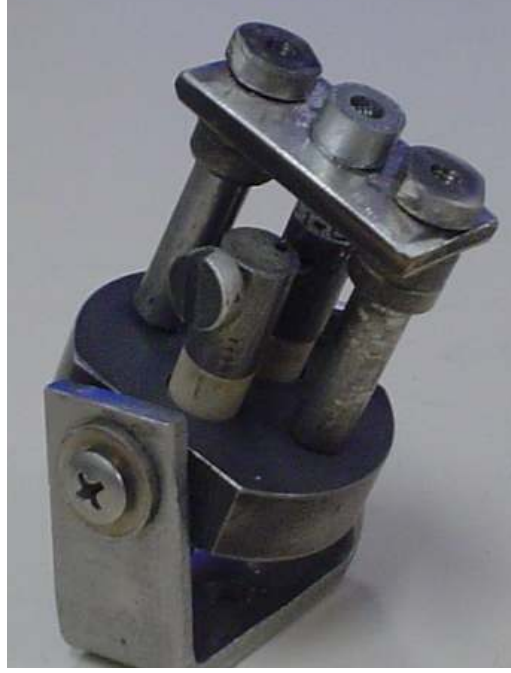
Şekil 5.5. TVA için elektron emisyonu sağlayan, içinde doğrudan ısıtılan katottun bulunduğu elektron tabancasının fotoğrafı.
