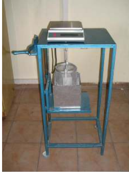
Şekil 8.4 Suya doymun numunelerin tartımında kullanılan arşimet terazisi
