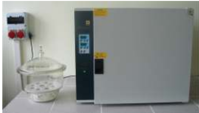
Şekil 8.3 Soğutma işleminde kullanılan desikatör ve kurutma işleminde kullanılan etüv
