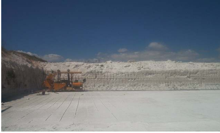
Şekil 7.1 Derbent taş kesme ocağında zemin dilimleme işlemi
