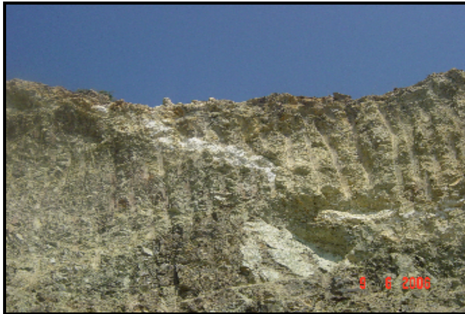
Şekil 6.3. Fay içerisinde dolgulanmış manyezit
