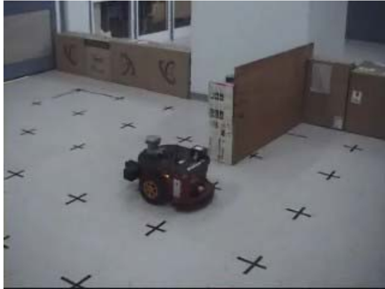
Şekil 6.17: Robotun 180 derecelik dışbükey köşeyi dönmeye başladığı durum
