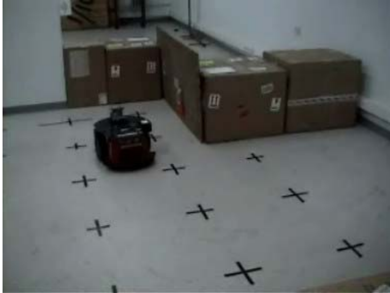
Şekil 6.15: Robotun 90 derecelik köşeyi dönmeyi tamamladığı durum
