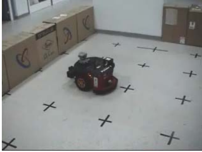
Şekil 6.10: Robotun en yakın duvarı bulduğu ve o yöne doğru gitmeye başladığı durum
