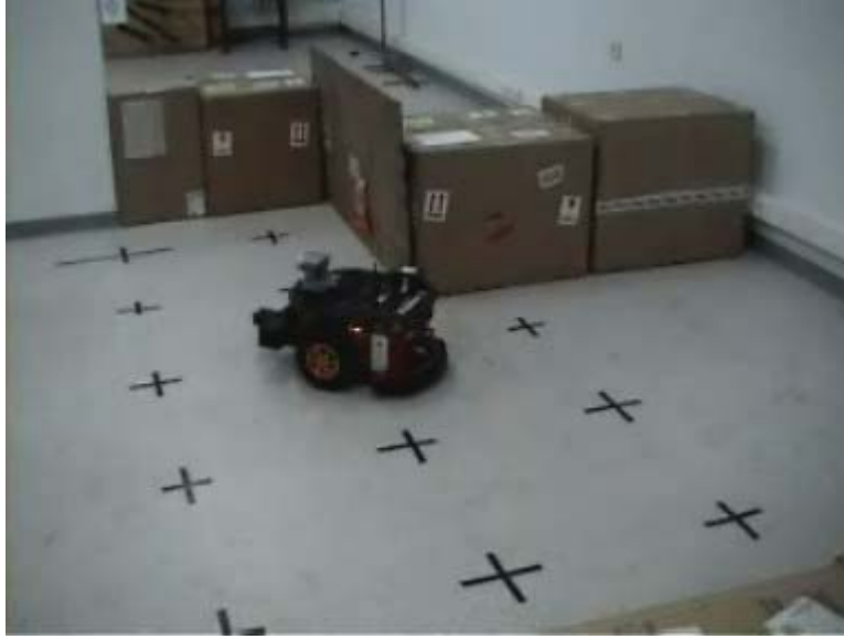
Şekil 6.14: Robotun 90 derecelik köşeyi dönmeye başladığı durum
