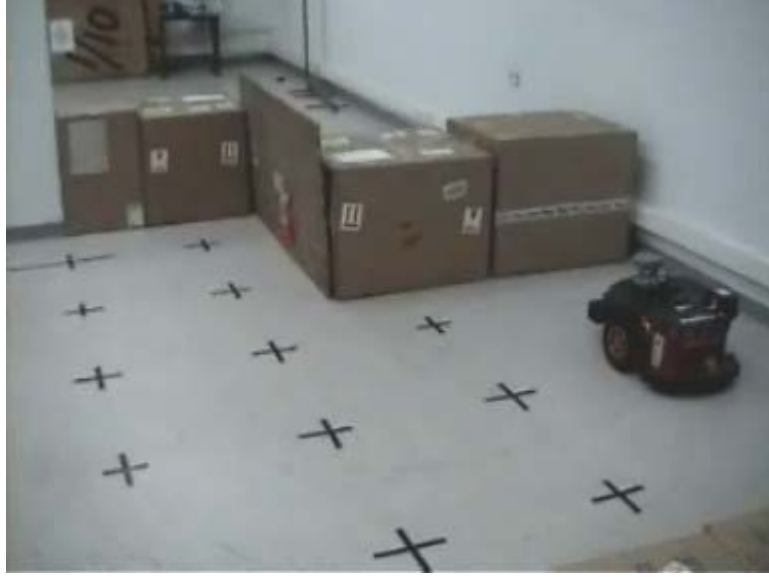
Şekil 6.12: Robotun duvara paralel halde duvar takip ettiği durum
