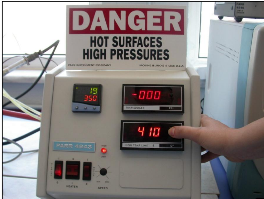
Şekil 6.5. Hidrojen depolama deney düzeneği kontrol ünitesi.
