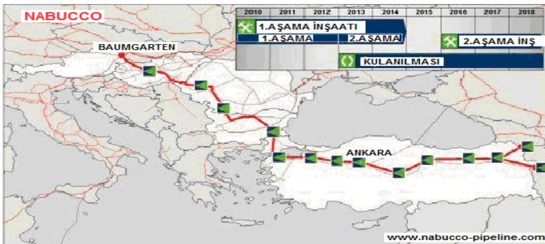
Şekil 4.18. NABUCCO Yapım Aşamaları [nabucco-pipeline, proje,2008]
