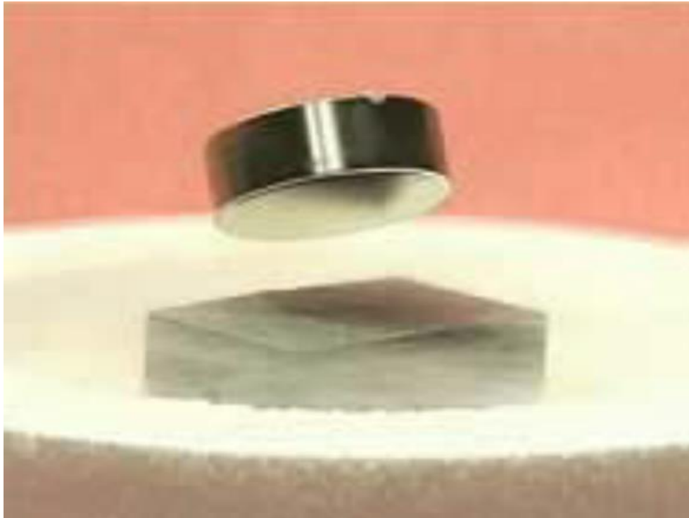
Şekil 2.11. Kritik sıcaklık değerine veya altına soğutulmuş olan bir süperiletken disk üzerinde yer alan mıknatısın manyetik alanı süperiletkende de manyetik alan oluşmasını sağlamasıyla her iki manyetik alanın birbirini itmesi sonucunda mıknatısın havaya yükselmesi (Balakan, 2008).
