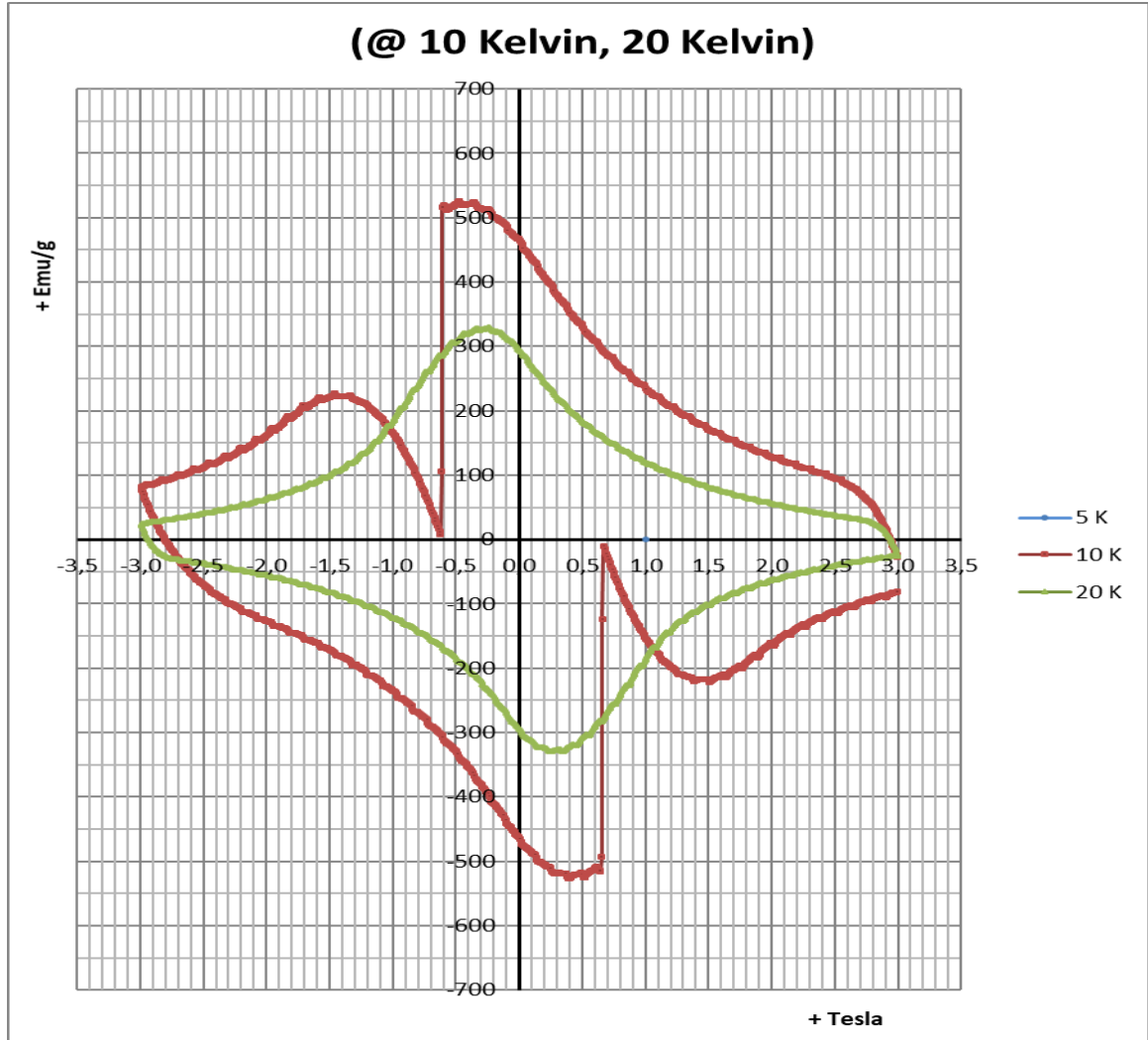
Şekil 4.37. Katkısız MgB_2 numunesinin VSM manyetizma ölçüm sonuçları. [Manyetik histeresis eğrileri (öğütme parametreleri; 1:3 kütle/bilye oranında, 11.2mm bilyelerle, 2saat)
