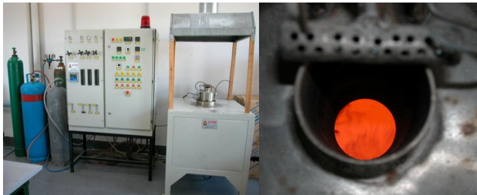
Şekil 2.11 Akışkan yataklı fırın ve haznedeki akışkanlaşma durumu (Topuz, 2009).
