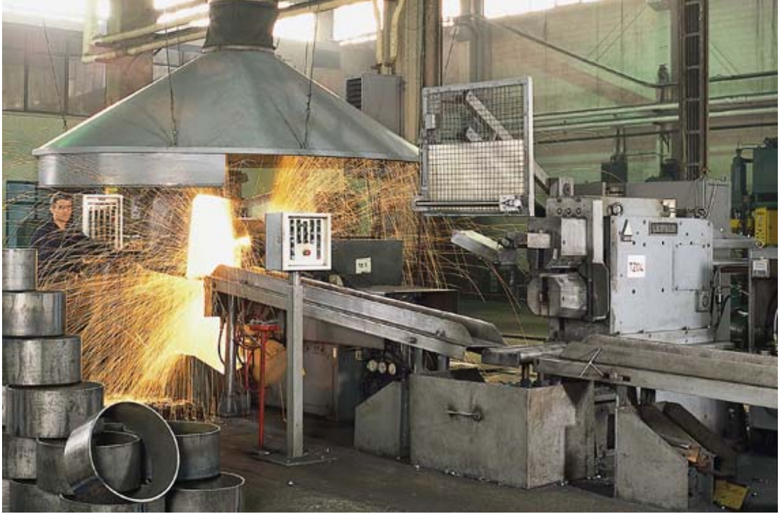
Şekil 3.8. Yakma alın kaynak hattı - Leifeld (JMS'den, 2006).
