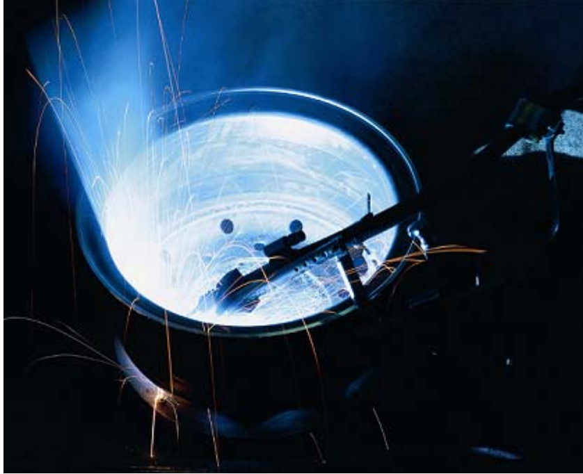
Şekil 3.15. Gazaltı kaynak ile kasnak ve göbeğin birleştirilmesi (JMS'den, 2006).
