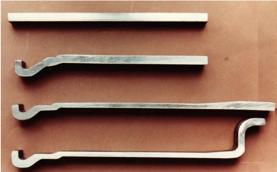
Şekil 3.12. Sıvama ile kasnak üretiminde oluşan farklı profil kesitleri (JMS'den, 2006).
