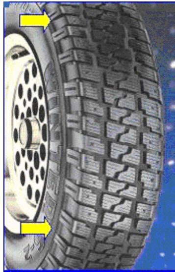
Şekil 2.7. Çivili otomobil kış lastiği (Pirelli'den, 2006).
