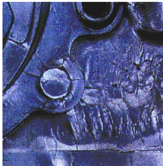
Şekil 7.2. Sıcak iş kalıp çeliği yüzeyinde oluşan erozyon ve korozyon hasarı (Ganiyusufoğlu'ndan, 2005).
