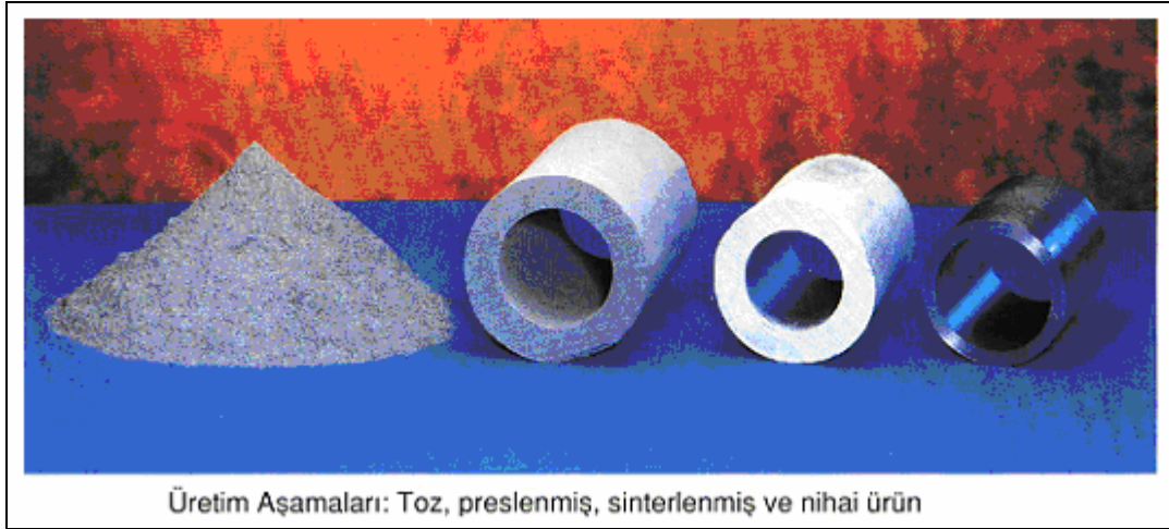
Şekil 6.5. Toz Metalürjik çeliklerin üretim aşamaları (Koçak'tan, 2006).
