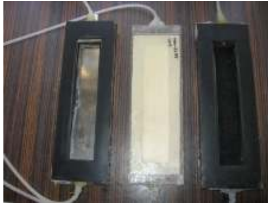
Şekil 5.4. Elektrodiyaliz hücresinin bölümlerinin gösterimi (Soldan sağa; katodik bölüm, orta bölüm, anodik bölüm)
