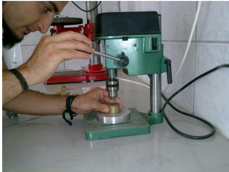
Şekil 3.10. Numune içinde delik açılması.
