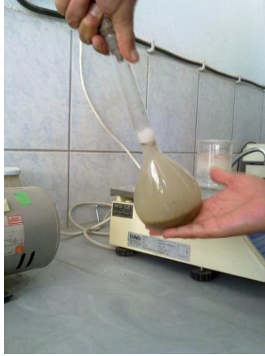
Şekil 5.8. Vakum pompası yardımı ile havanın alınması
