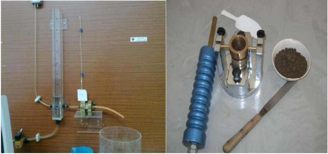
Şekil 3.11. İğne deliği deney ekipmanı
