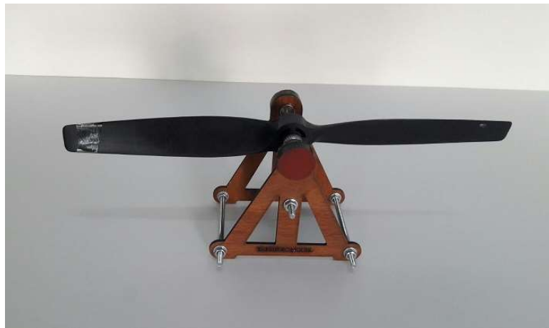
Şekil 3.5. Pervane balansı test düzeneği
