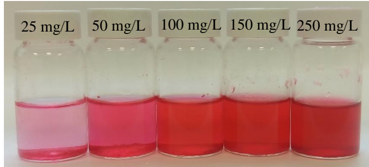
Şekil 4.118. MS11 kodlu polimer içeren farklı derişimlerde AR boyarmadde çözeltilerinin fotoğraf görüntüsü (t=24 sa).
