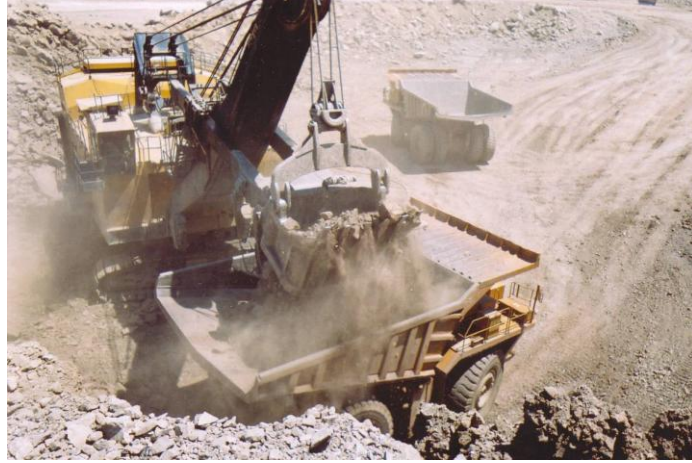
Şekil 4.5. Komatsu 630Es kamyona ykleme yapılırken
