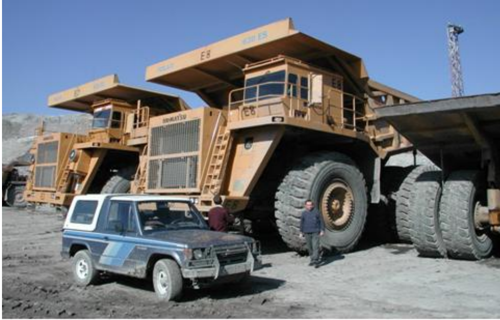
Şekil 4.2. Komatsu 630Es elektrikli kamyon
