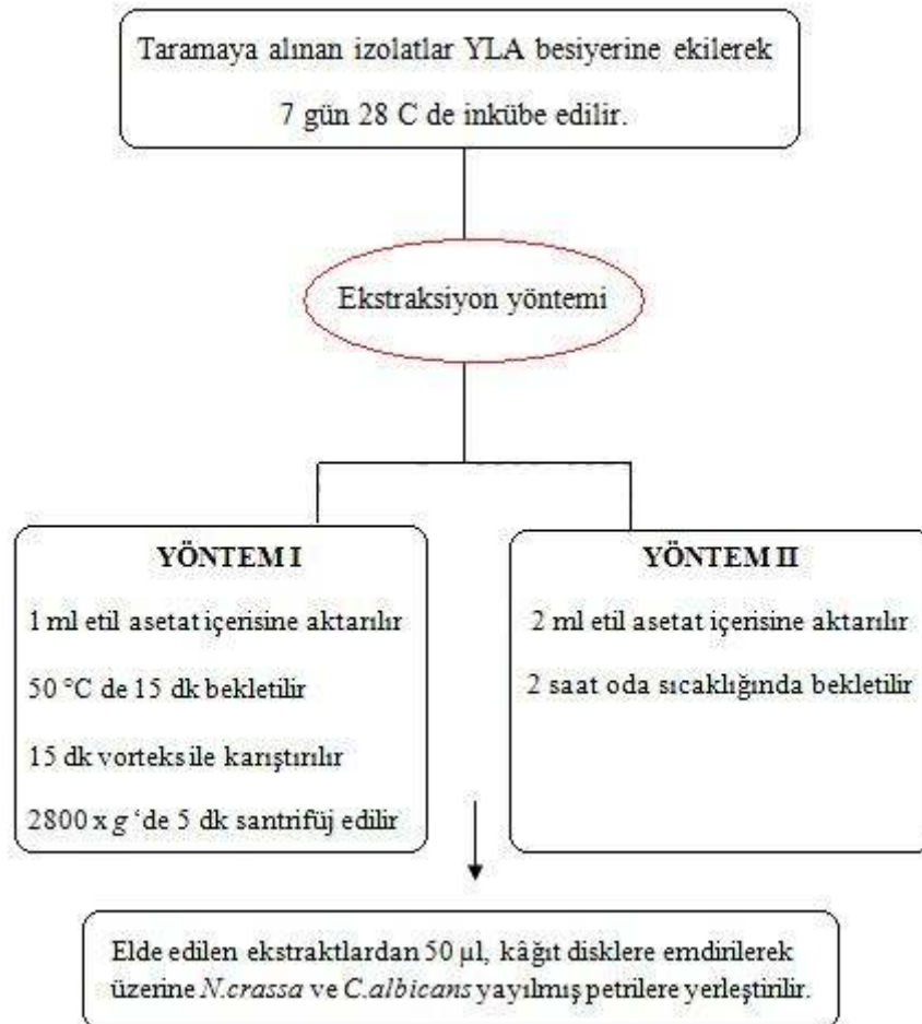
Şekil 2.1. Statin ekstraksiyonu ve biyotayininin genel akış şeması
