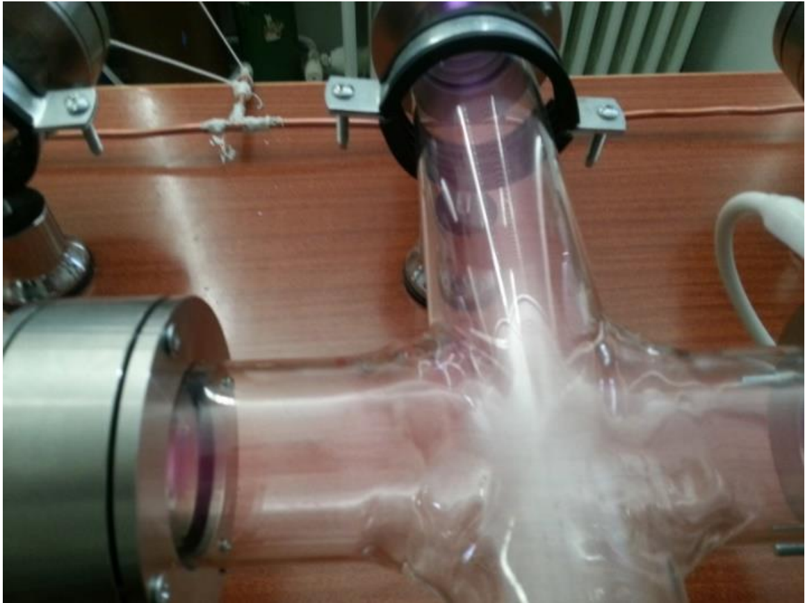
Şekil 5.14. Oksijen gazınındeşarj odasındadeşarj plazmasının üretimi.
