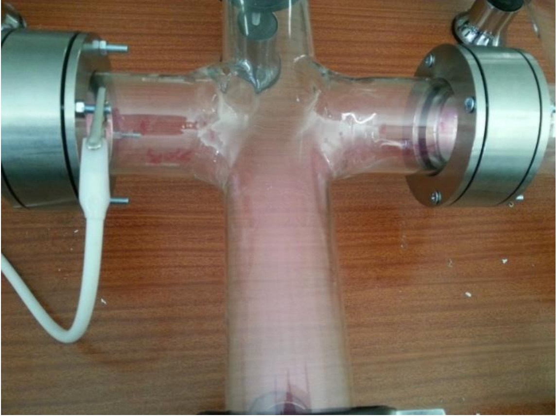
Şekil 5.15. Oksijen gazının etkileşim odasında post-deşarj plazmasının üretimi.
