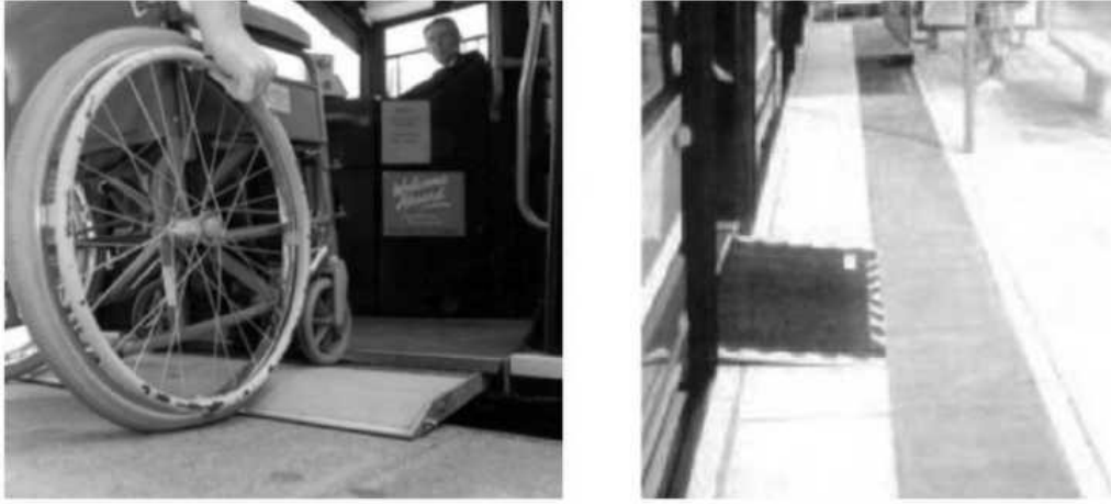
Şekil. 3.6. Basit Rampa Uygulaması Örneği
