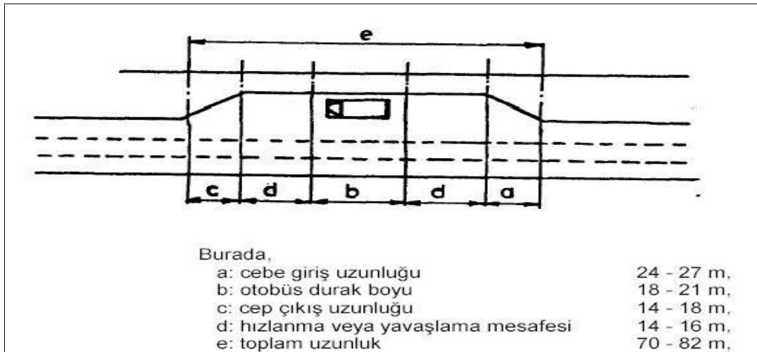
Şekil 3.5. Otobüs Durak Cep Standartları (TSE 11783, 2014)
