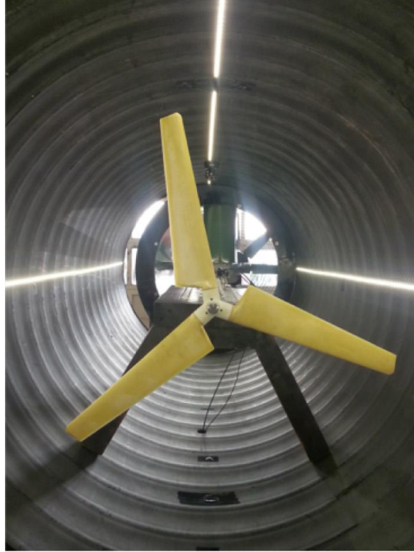
Şekil 2.5. Rüzgar Tünelinde Türbinin Yerleşimi (MacPhee ve Beyene, 2015).
