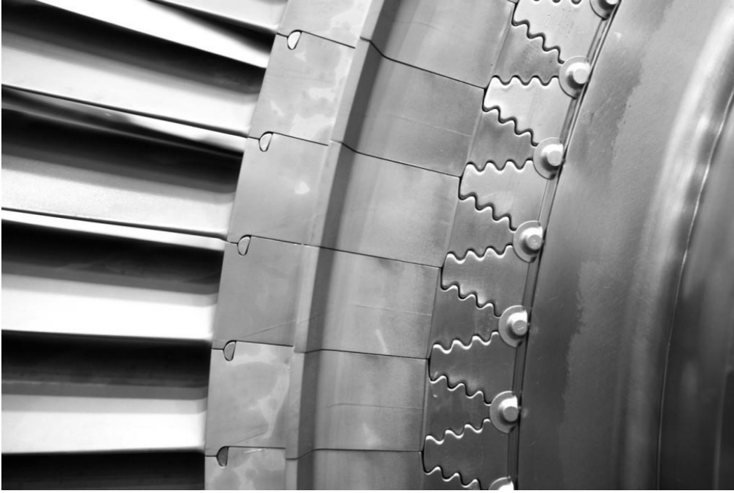
Şekil 3.11: Bir Güç Türbininde Kanatçık Disk Montajı (Kellner, 2015).
