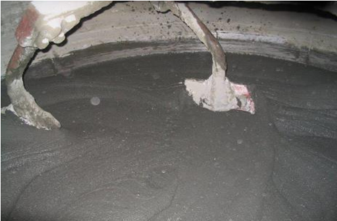
Şekil 3.2. Çimento esaslı lifli kompozit harcının karıştırılması
