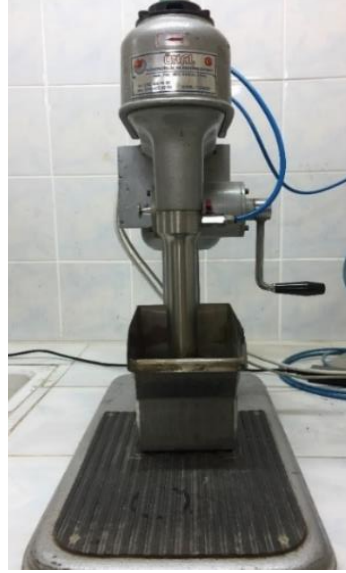
Şekil 3.6. Deneylerde kullanılan flotasyon makinesi
