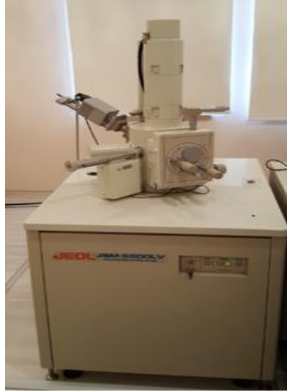
Şekil 3.22. SEM görüntülerinin alınmasında ve EDX analizlerinde kullanılan JEOL JSM-5600LV taramalı elektron mikroskobu.
