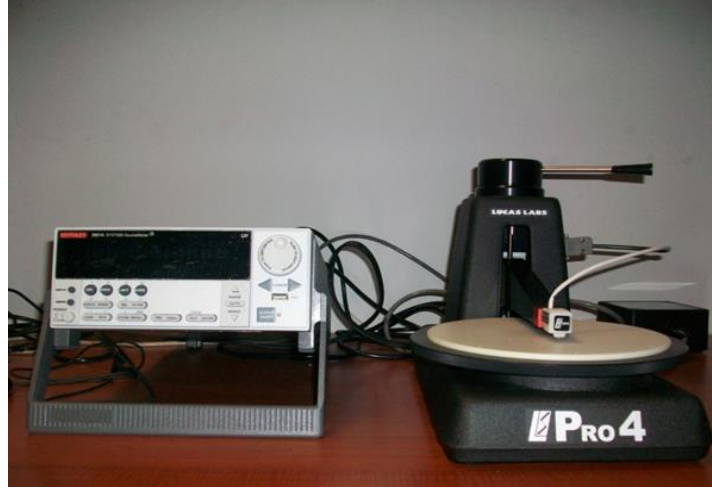
Şekil 3.21. Lucas Labs Pro 4 - Keithley 2601 A System Sourcemeter dört uç sistemi.
