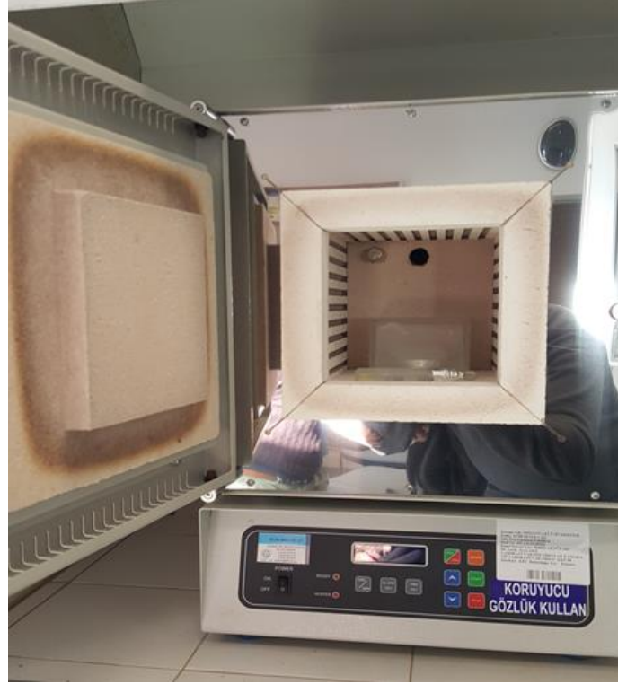
Şekil 3.5. Sülfürleme işleminde kullanılan kamara tip fırın.
