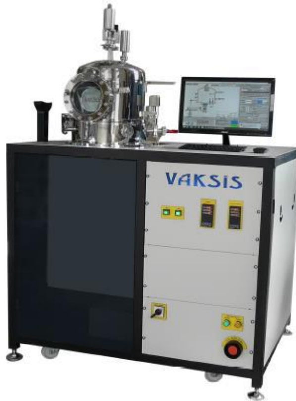
Şekil 3.1. PVD Handy/2T dirençli ısı buharlaştırma sisteminin fotoğrafı.
