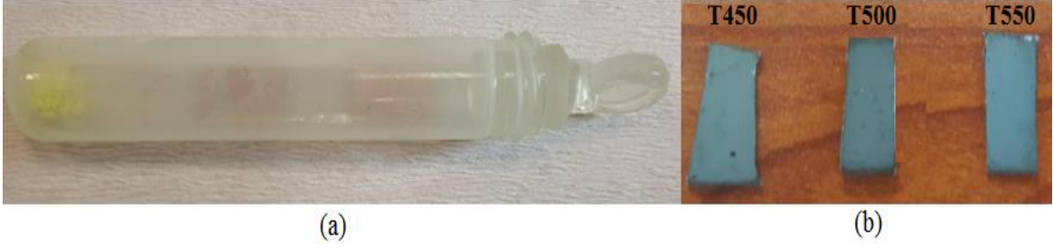
Şekil 3.7. (a) T450, T500 ve T550 kodlu numunelerin üretiminde kullanılan 7cm 3 ' lük deney tüpü, (b) Sülfürleme işleminin başarı ile gerçekleştirilmesi sonucunda elde edilen CZTS filmleri.
