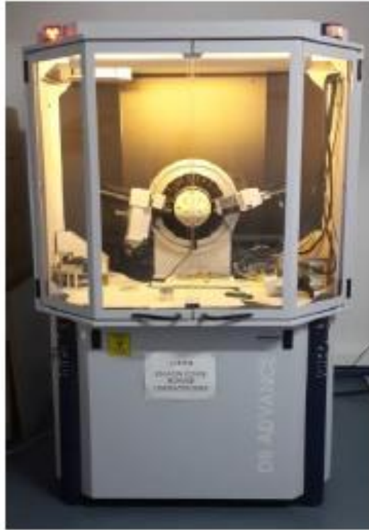
Şekil 3.17. X-ışını kırınım desenlerinin alınmasında kullanılan Bruker Advance D8 cihazı.
