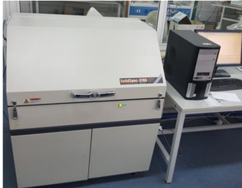
Şekil 3.19. Shimadzu SolidSpec-3700 UV-VIS-NIR Spectrophotometer cihazı.
