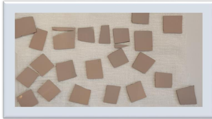
Şekil 3.4. PVD Handy/2T dirençli ısı buharlaştırma sistemi ile elde edilen CZT öncül kaplamaları.
