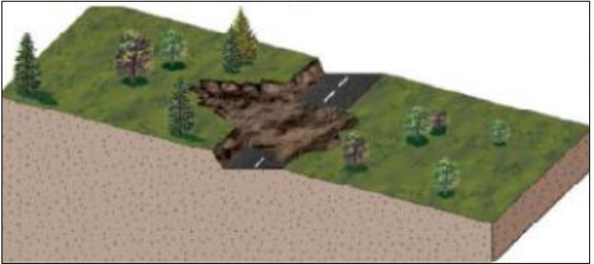
Şekil 2.23. Eğimli arazide açılan yol yarmasının şev yenilmesine yol açması.
