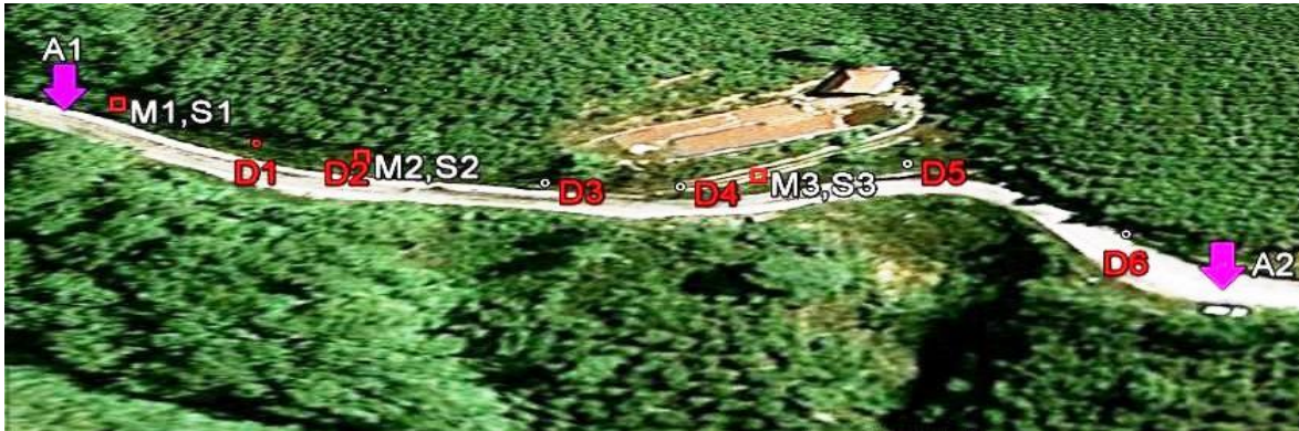
Şekil 4.13. Masw yöntemi, Düşey elektrik sondaj yöntemi ve sismik yöntemleri uygulama noktaları M; Masw yöntemi, D; Düşey elektrik sondaj yöntemi, S; Sismik yöntem.
