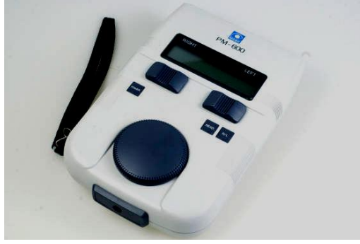
Şekil 6.2. Nidek marka PM-600 model dijital pupilometre (Opticalmarketplace'den, 2017)
