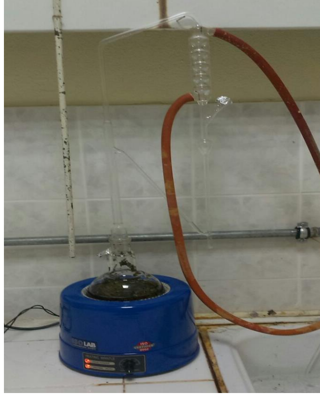
Şekil 4.2 Su-buhar destilasyonu sistemi
