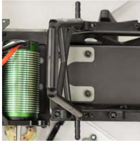
Şekil 3.2. Kullanılan Castle 2028 Extreme 800Kv Autorally Motor
