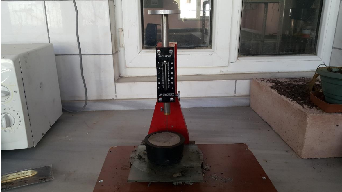
Şekil 3.2. Priz süresi deney düzeneği (Vicat iğnesi)
