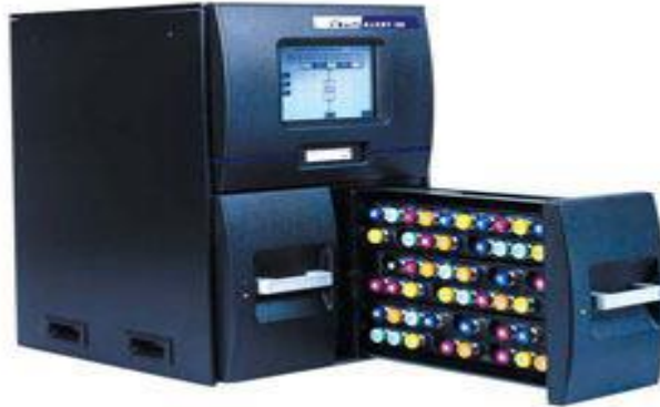
Resim 2.4 BacT/Alert 3D kan kültür sistemi
