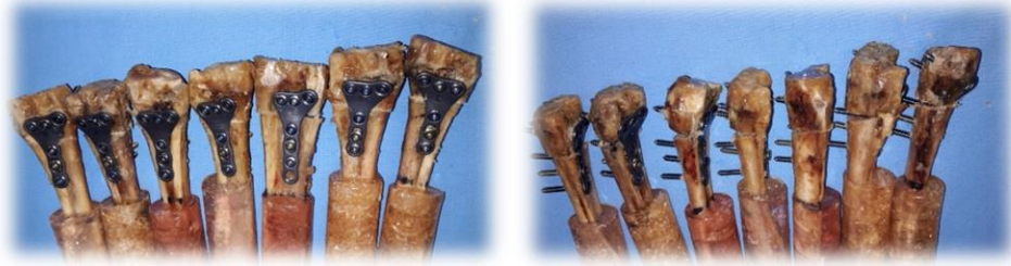
Şekil 3.6. Kilitli volar plakla tespit edilmiş materyaller
