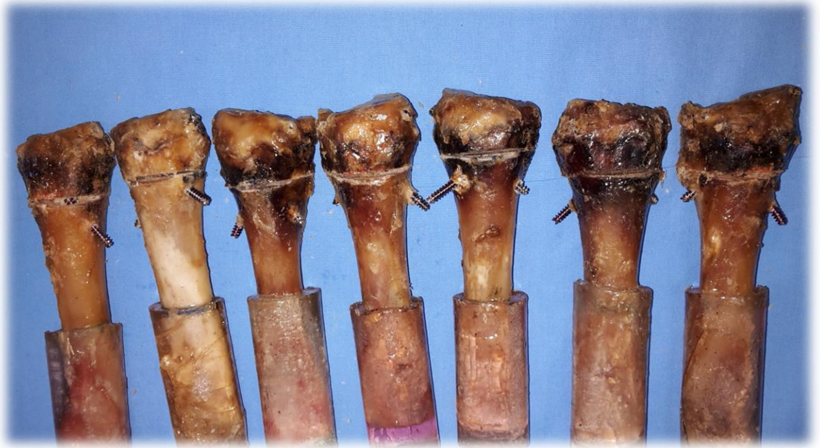
Şekil 3.5. Konik kompresif vida ile tespit edilmiş materyaller
