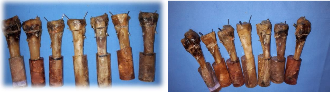
Şekil 3.7. Kirschner telleriyle tespit edilmiş materyaller
