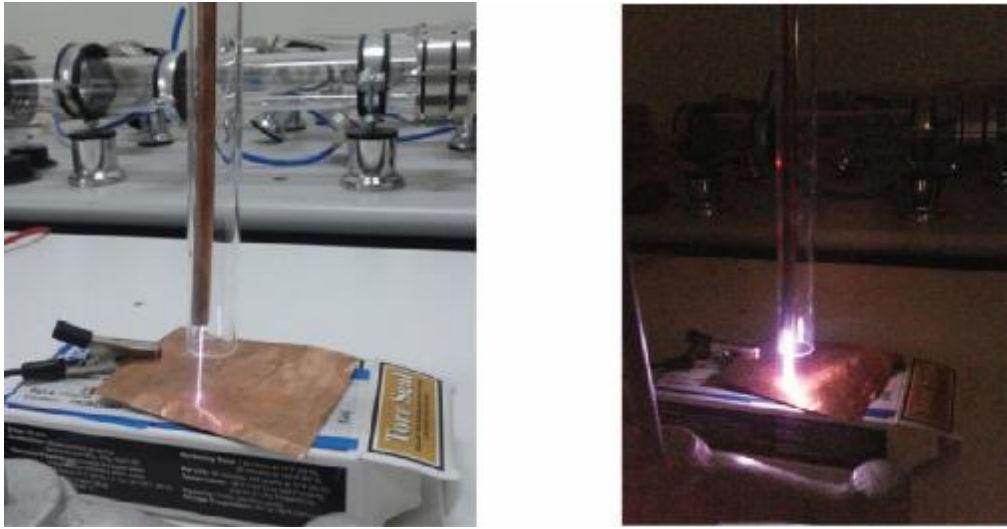
Şekil 5.9. Metal boru-toprak elektrot argon plazma jet üretimi.
