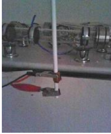
Şekil 5.7. Tek elektrot ile seramik boru argon plazma jet üretimi.
