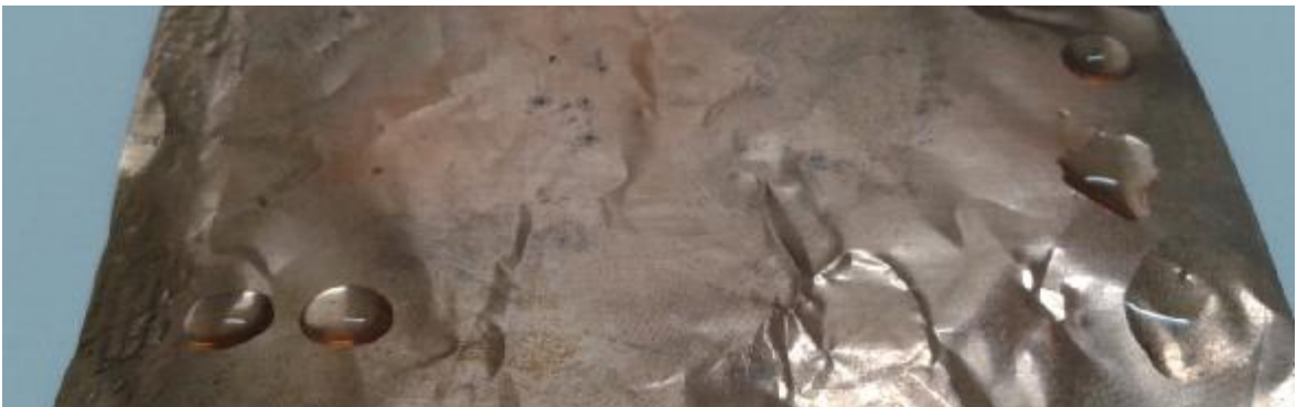
Şekil 5.13. Argon plazma jet ile bakır yüzey üzerine uygulama.
