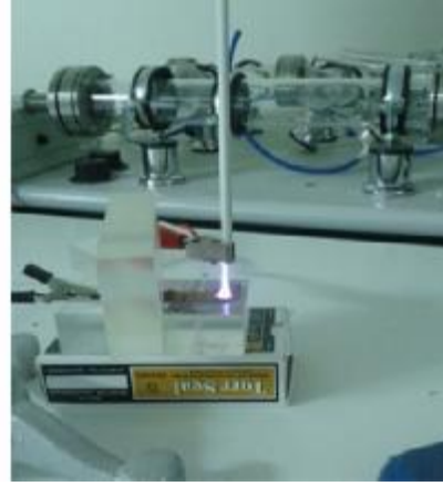
Şekil 5.7. Tek elektrot ile seramik boru argon plazma jet üretimi.
