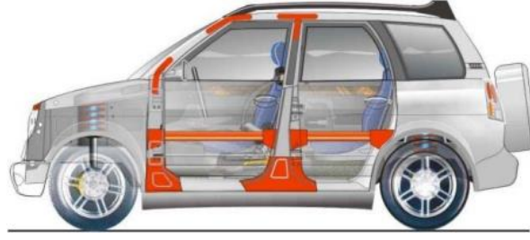
Şekil 4.4 Destek çubukları, köşe takviyeleri ve levhalar (Watson, 2008)
