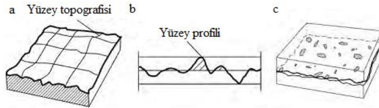
Şekil 3.3. a) Yüzey şekli yüzey topografisi olarak adlandırılmıştır, b) yüzey profili, c) temas halindeki iki yüzeyin gerçek temas alanı (Holmberg ve Matthews, 2009)
