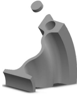
Şekil 7.3 Teker numunelerinin tekerden çıkarıldığı kısım
