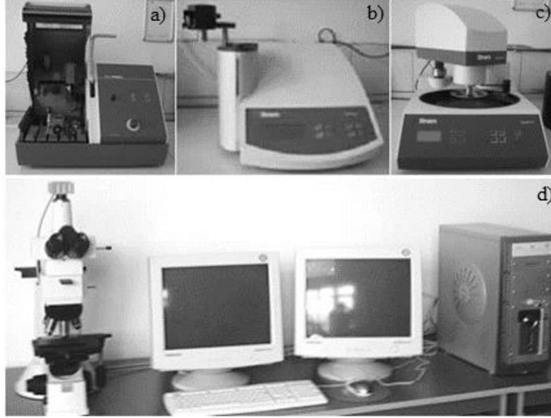
Şekil 7.9 a) Struers Discotom 50 kesme cihazı, b) Struers CitoPress-1 kalıplama cihazı c) Struers Tegraforce 4500 zımparalama ve parlatma cihazı, d) Nikon Eclipse L150 görüntü analiz sistemi
