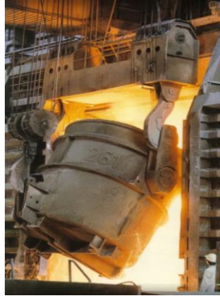
Şekil 2.9 Dönüştürücünün potaya eriyik metali aktarma anı (Esveld, 2001)
