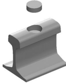
Şekil 7.1 Hızlı tren üstyapısında kullanılan raydan numunelerin çıkarıldığı kısım
