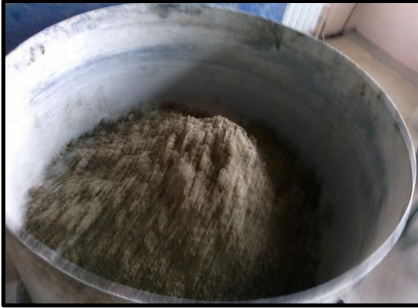
Şekil 3.4. Çimento harcının betoniyerde hazırlanması (çimento ve kum karışımı)
