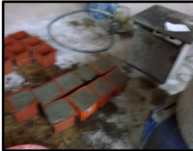
Şekil 3.6. Köpük betonun numune kalıplarına dökülmesi
