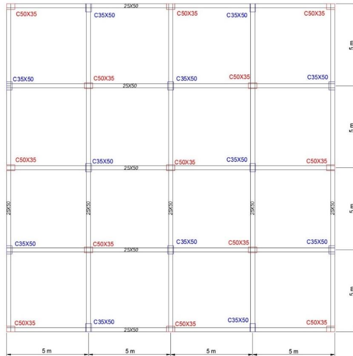
Şekil 3.8. 4x4 açıklıklı modellerde normal kat kalıp planı
