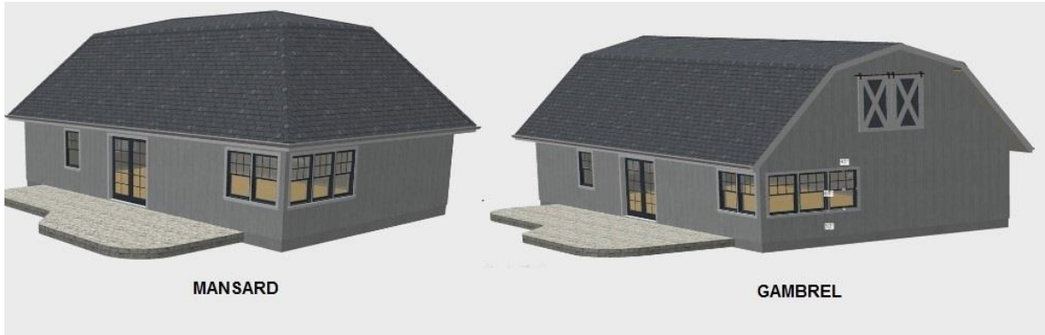
Şekil 1.1. Mansard ve Gambrel tipi çatılar (Anonim, 2016 b)
