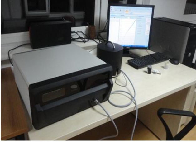
Şekil 5.16. Sıcak disk termal iletkenlik cihazı ve numune sensörü.
