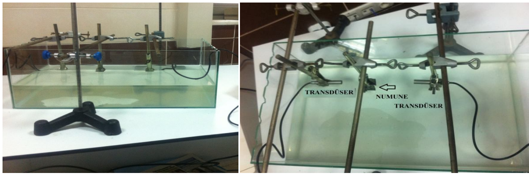
Şekil 5.8. Daldırma yönteminin deneysel kurulumu.
