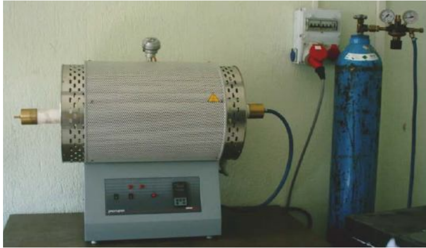
Şekil 5.4. Argon gazı atmosferinde sinterleme işlemi için kullanılan tüp fırın.
