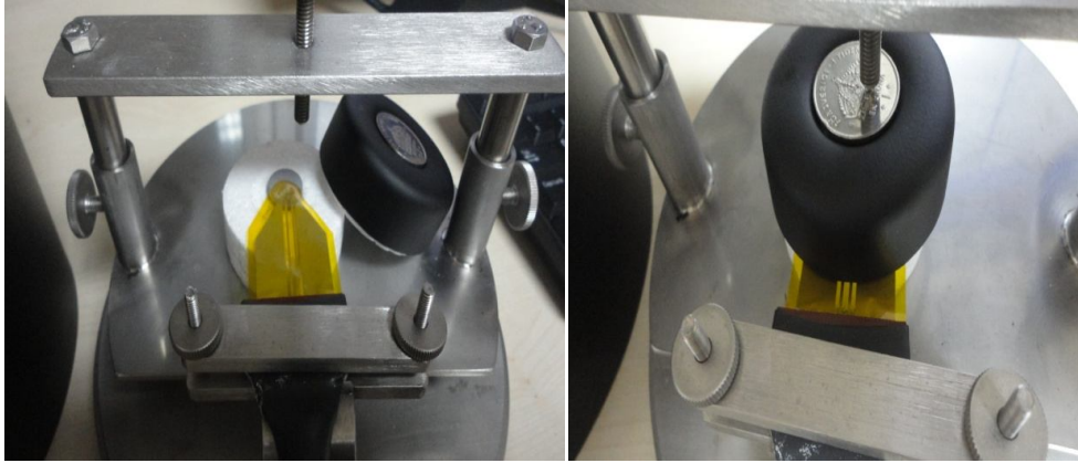
Şekil 5.17. Sıcak disk numune tutucuları ve sensörü.
