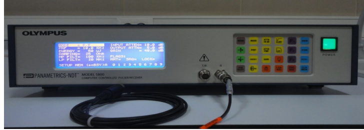
Şekil 5.11. Ultrases ölçümlerinde darbe-yankı yöntemi için kullanılan pulser-receiver.
