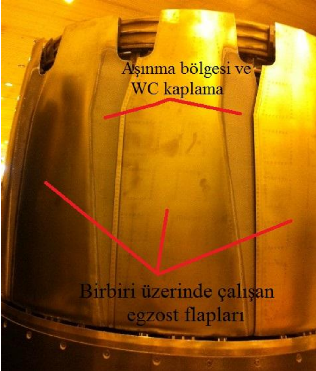
Şekil 2.17. Jet motor egzost flapları ve WC kaplamalı bölge
