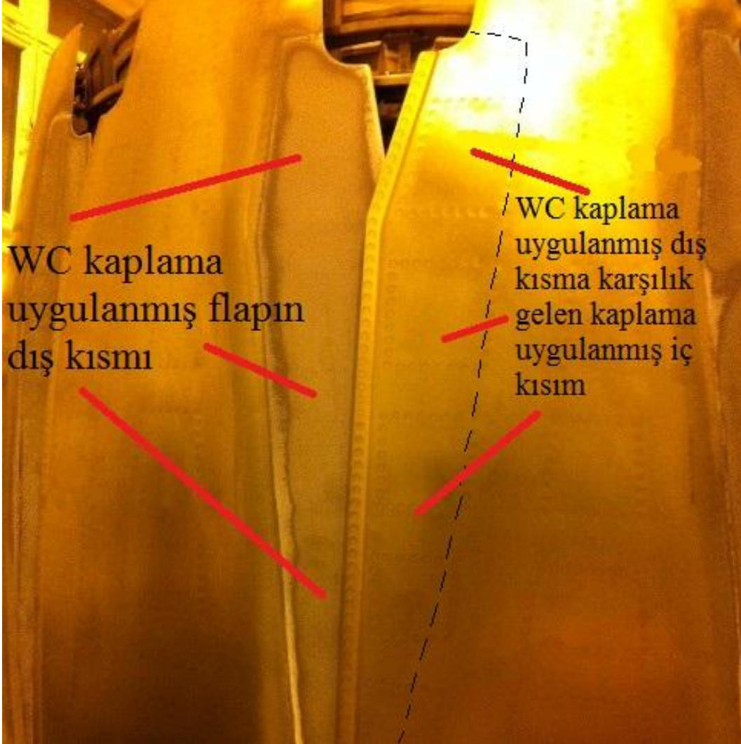
Şekil 2.18. Flaplarda birbiri üzerinde çalışan ve WC kaplamalı bölgeler
