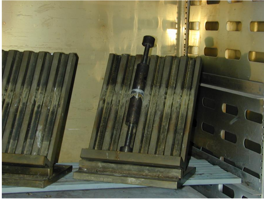
Şekil 3.9. Fırın içerisinde yapıştırıcı kürleşme işlemine tabi tutulmuş, fikstür yardımıyla çekme çubuğu haline gelmiş çekme test numunesi.
