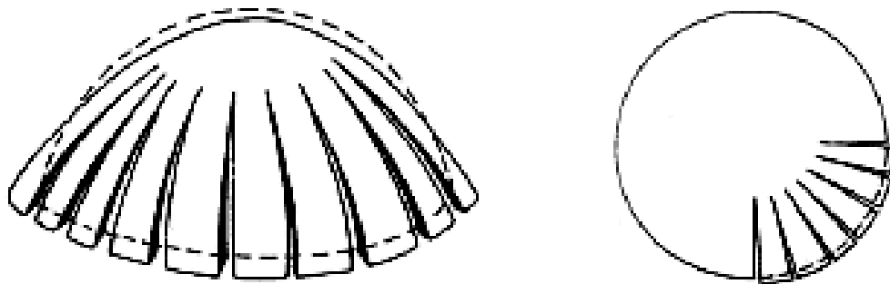
Şekil 9.15: Kubbede tipik hasar biçimleri
